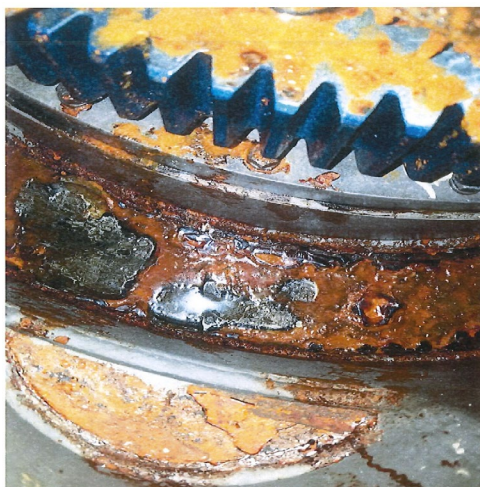
Figura 3-2 — Condición del engranaje del clasificador rotatorio
